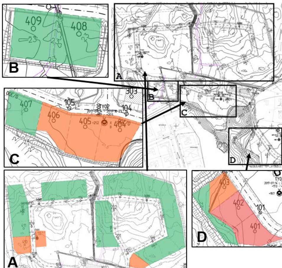
Figur 8. Grundläggningsrekommendationer inom utredningsområdet. I övre högra hörnet syns hela utredningsområdet och delområdena A, B, C och D. Gröna områden indikerar plattgrundläggning, orangea områden indikerar plattgrundläggning efter att urskiftning av lera gjorts. Röda områden indikerar pålgrundläggning.
