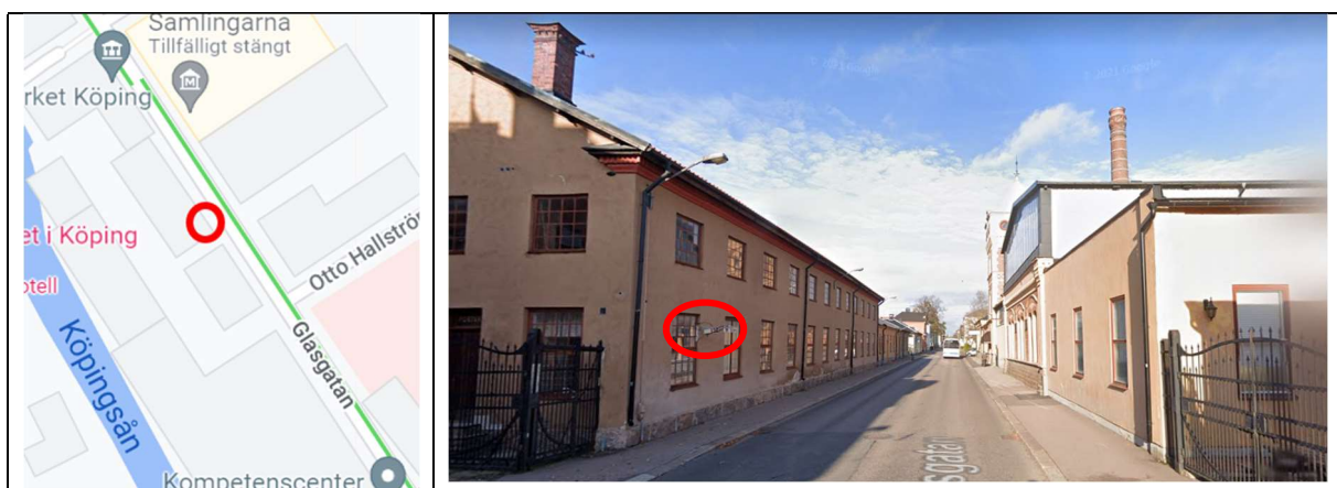
Fig. 2: Mätstationens placering på Glasgatan på kartan (vänster) samt gaturummets utseende i riktning mot NNV. Vägbanan är ca 5 m bred och gaturummet (avstånd mellan byggnader) 8 m. Byggnaden till vänster är ca 10 m hög, byggnaderna till höger mellan 6 och 12 m höga.
