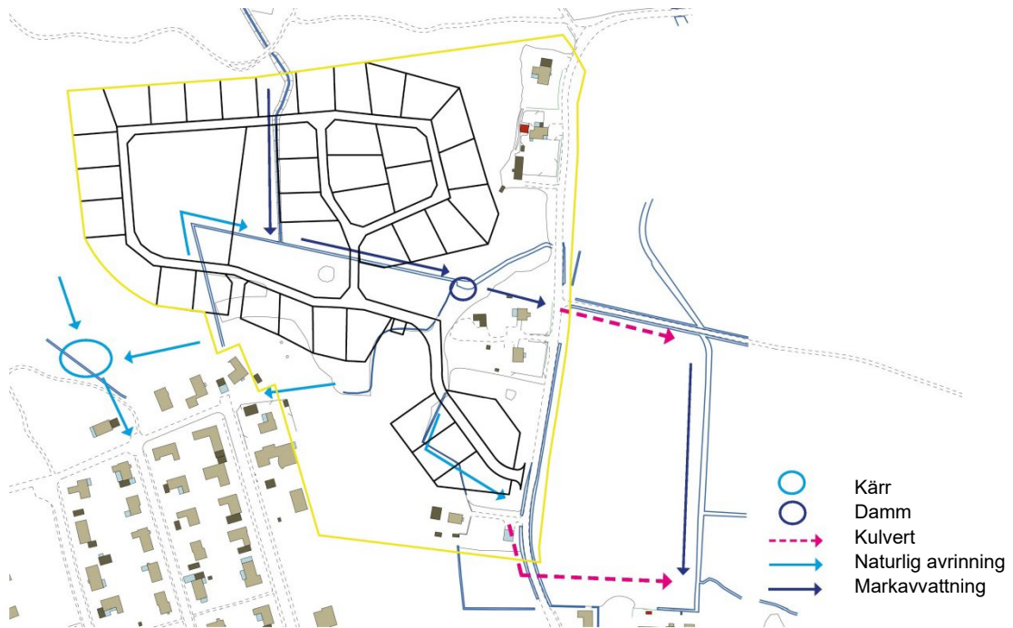
Befintlig avrinning och avvattning från planområdet
